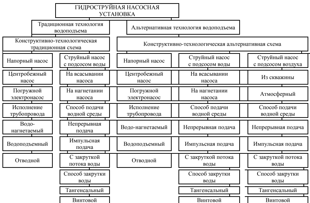
Рисунок 1 – Классификация гидроструйных насосных установок
